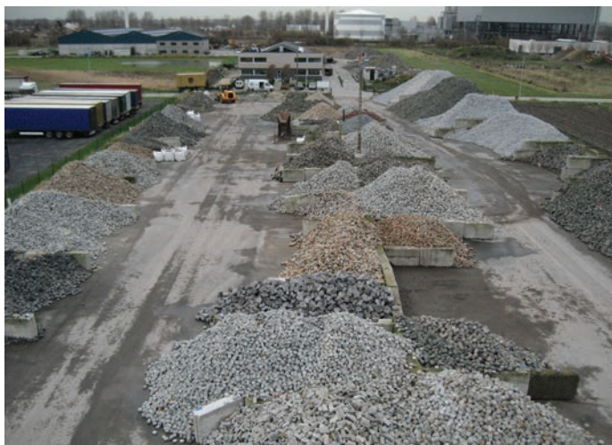
→ Le stock de porphyre de Keda, les mosaïques de pavés portugais et les matériaux de réemploi (porphyre belge).
